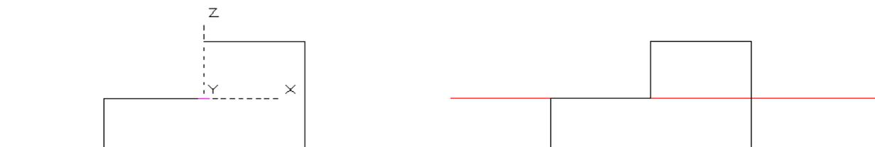
Рабочий план так же можно установить По фасете любого твердотельного объекта. В процессе перемещения курсора по граням объекта, они будут выделяться зеленым цветом и появятся оси рабочего плана.
